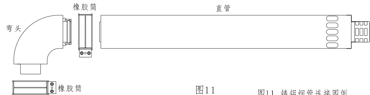
图11 铸铝烟管连接图例
